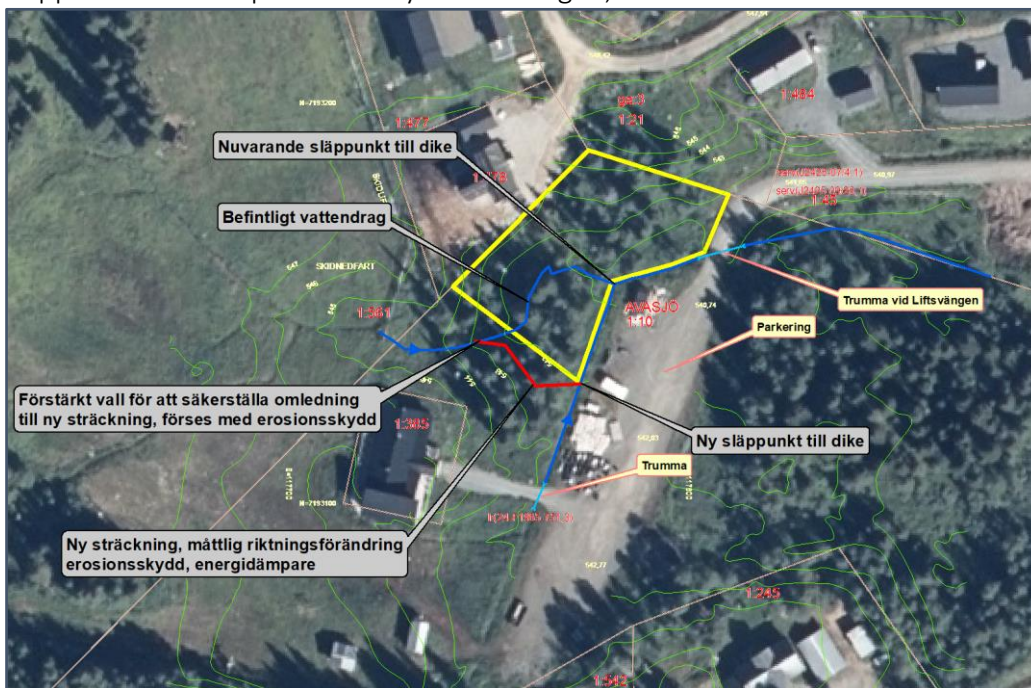
Skiss 1. Visar planerad omledning av vattendraget.
