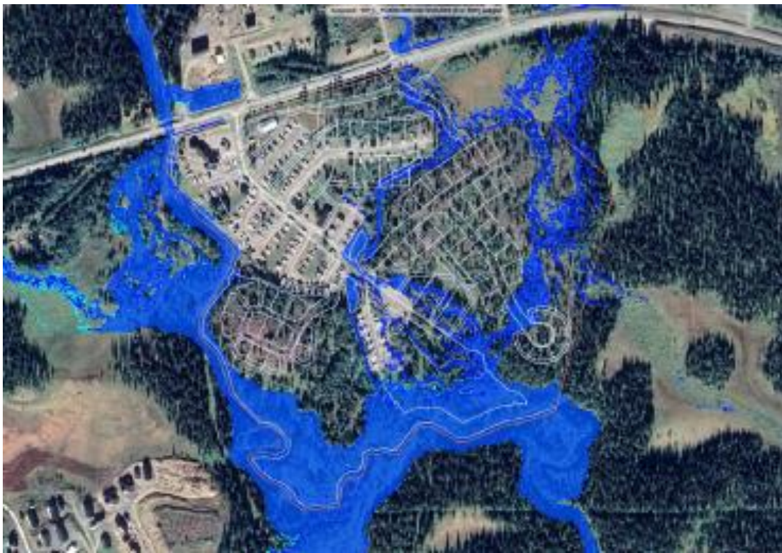
Översvämningskartering 100 årsregn Avasjö 1.324 mfl i Tyréns utredning Vattenutbredning för vattendjup större än 10 cm. 100-årsflöde ses i mörkblått och 200-årsflöde i turkos, det nya detaljplaneförslaget ses med vita streck.
